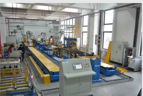
充气环网柜焊接智能生产线
