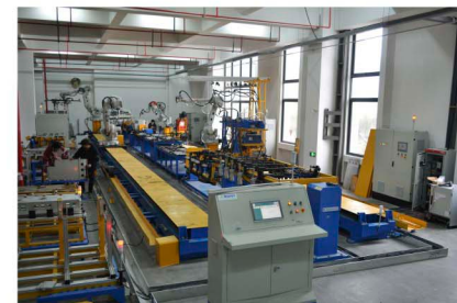
全自动环网柜焊接生产线
