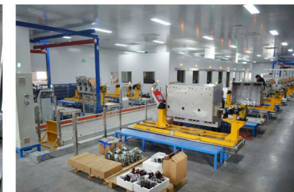
智能环网柜生产线
